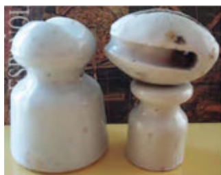
Figura 51. Aislantes para los cables trenzados. Imagen de los autores.
