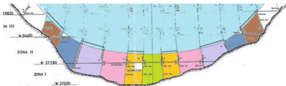
Figura 195. Curva límite de cimentación o realce perimetral. E18.11. ADF.
