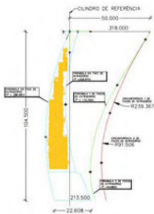
Figura 219. Ménsula central de la presa de Támeга.
