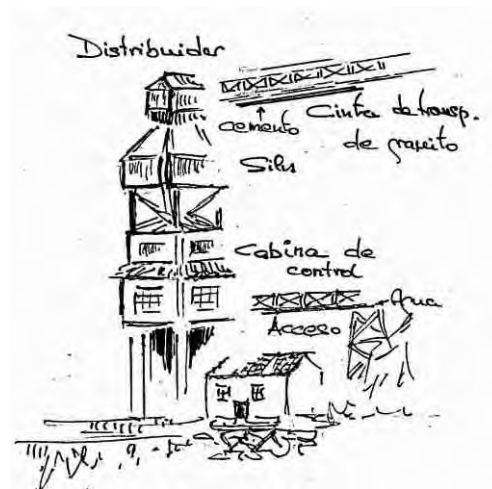
Figura 114. Dibujo de la torre de hormigonado. Autores.
