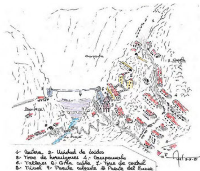
Figura 282. Panorámica con la infraestructura necesaria para la construcción de la presa. Autores.
