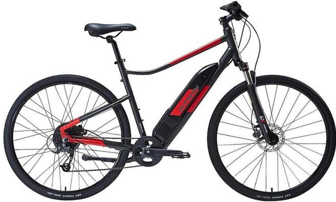
Bicicleta equipada con un motor eléctrico auxiliar de potencia continua máxima inferior o igual a 250 W que disminuye progresivamente y finalmente se interrumpe antes de que la velocidad alcance los 25 km/h o si el ciclista deja de pedalear (anexo II RGVEH)
